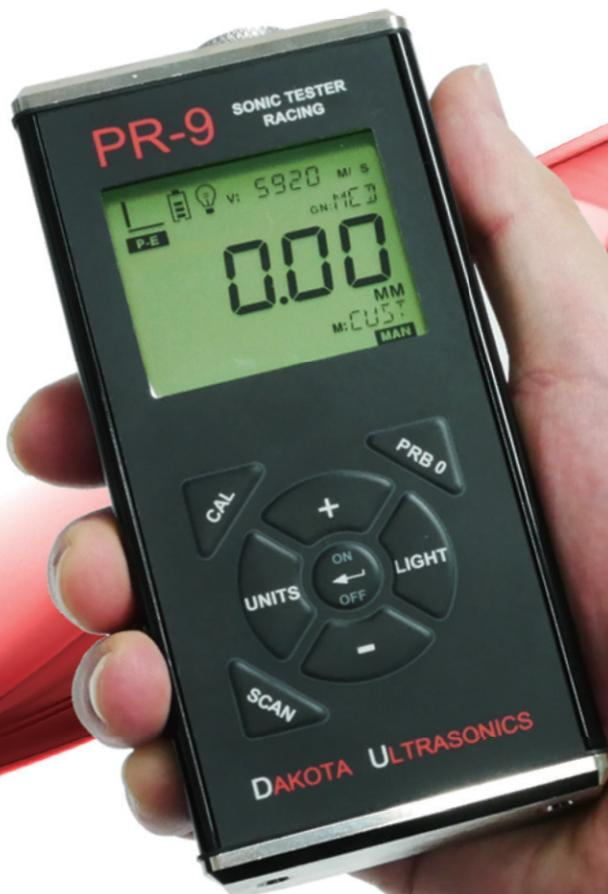
鋳鉄は、結晶粒が粗大でエコーが拡散し易いため、一般的な超音波厚さ計では測定が難しい材料です。PR-9は、鋳鉄・鋳造アルミ測定用に開発・調整されており、鋳鉄特有のノイズを回避し底面エコーを確実に検出します。
