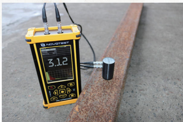
酸化被膜 (錆・スケール) が生じた鉄板・配管
